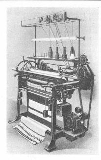
Abb. 28. Motorangetriebene Wirkmaschine.
