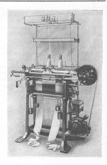
Abb. 29. Motorangetriebene Bandstrickmaschine.
