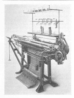
Abb. 26. Halbautomatische Jacquard-Strickmaschine.
