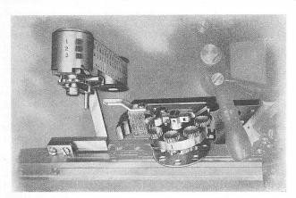
Abb. 30. Zusatzapparat "Super 8" für Handstrickmaschinen.
