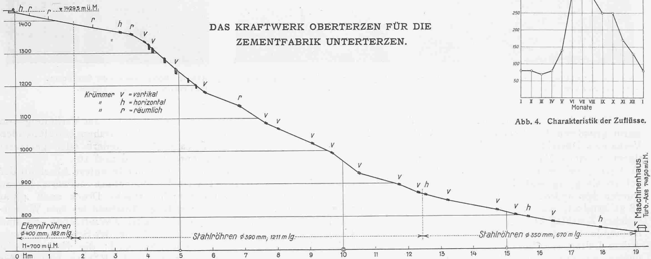
Abb. 9. Längenprofil der Druckleitung, Längen und Höhen 1:10000.
