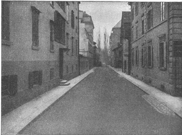
GLARNISCHSTRASSE ZÜRICH Walz-Asphalt: Topeka, 6 cm stark
