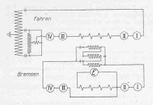
Abb. 7. Schaltungschema der vier Triebmotoren der Einphasenstrom-Lokomotive Visp-Zermatt.
