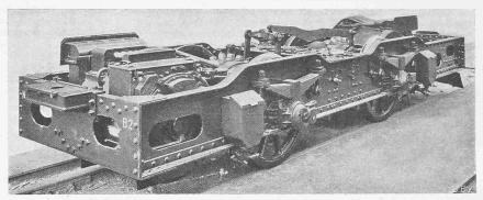
Abb. 6. Zweiachsiges Drehgestell mit zwei Triebmotoren,
