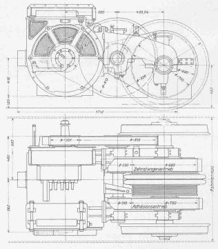
Abb. 5. Einphasenwechselstrom-Triebmotor für 160 PS Einstundenleistung bezw. 140 PS Dauerleistung.
