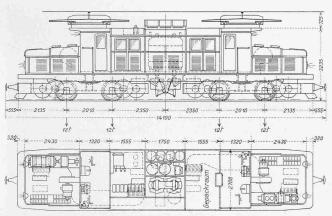
Abb. 4. Typenskizze der Lokomotive. - Masstab 1:130.
