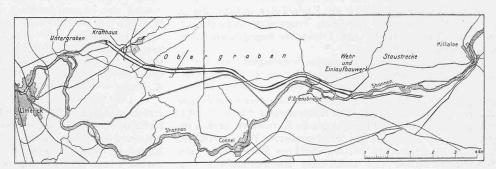
Abb. 1. Uebersichtsplan des Shannon-Kraftwerks. — Masstab 1:150000.
