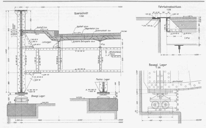
Abb. 3. Ausführungsdetails der neuen eisernen Brücke über die Reuss in Mellingen. - Masstab 1:50 und 1:25.
