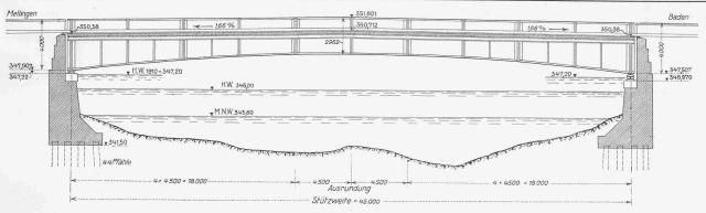
Abb. 2. Längsschnitt der neuen eisernen Brücke über die Reuss in Mellingen. — Masstab 1:300.
