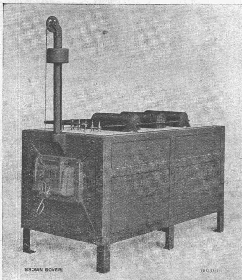
Elektrischer Glühofen Bauart Brown Boveri Nutzbarer Glühraum 1800 x 500 x 300 mm
