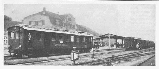
Abb. 1. Zwei Sulzer-Dieselmotor-Triebwagen in der Station Herisau.
