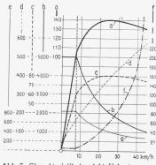
Abb. 7. Charakteristik der elekt. Uebertragung, Drehzahl des Dieselmotors bei voller Leistung: 775 Uml/min. — a Motorleistung in kW am Triebrad. b Zugkraft in kg am Triebradumfang. c Totaler Wirkungsgrad in °/o, d Klemmenspannung in Volt. e Stromstärke in Ampère. f Zeit in Minuten, während welcher die der vollen. Dieselmotorleistung (184 kW — 10 kW Hillsbetriebe) entsprechende Zugkraft abgegeben werden kann.
