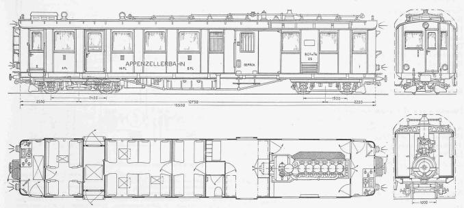
Abb. 2. Typenskizze 1:100 des Diesel-elektrischen Triebwagens der Appenzellerbahn.
