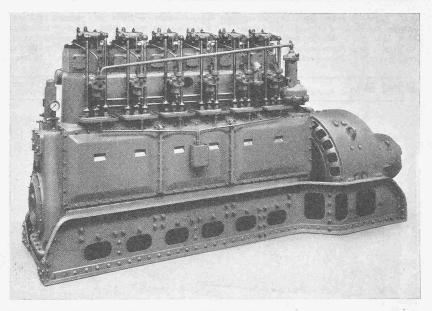
Abb. 3. Sechszylinder-Sulzer-Dieselmotor von 250 PSe mit luftloser Einspritzung.
