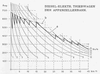
Abb. 6 Anfahrdiagramm des Diesel-elektrischen Antriebs beim Sulzer-Triebwagen, a = Grenzstromkurve für die volle Leistung des Dieselmotors.
