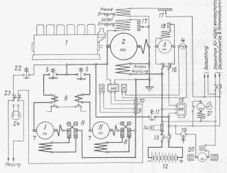
Abb. 5. Schaltungschema des Diesel-elektrischen Triebwagens.
