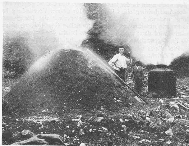
Abb. 4. Vergleichsversuche mit Meiler und tragbarem Ofen.
