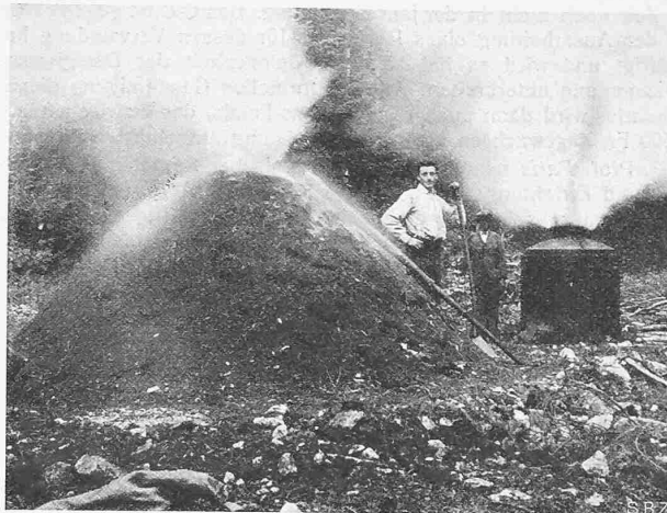
Abb. 4. Vergleichsversuche mit Meiler und tragbarem Ofen.
