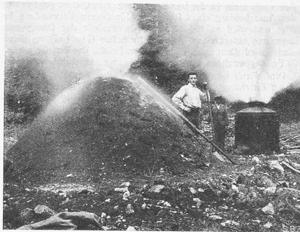
Abb. 4. Vergleichsversuche mit Meiler und tragbarem Ofen.
