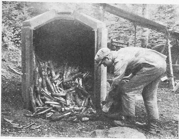
Abb. 3. Entleerung des Ofens nach der Verkohlung.
