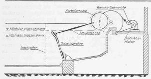
Abb. 1. Schematische Darstellung des Bamag-Wellenerzeugers.
