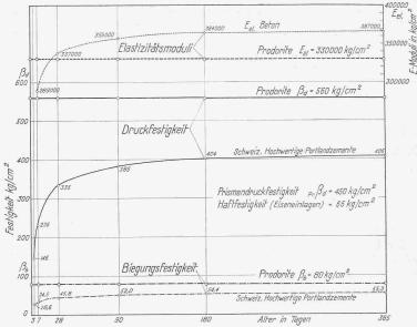
Abb. 2. Würfel-Druckfestigkelten, Biegezugfestigkeiten und Elastizitätsmoduli von Prodorite im Vergleich zu denen von Beton (300 kg/m³ Zementiösung, plastische Konsistenz, feuchte Luftlagerung). Prismen  $12\times12\times36$  cm.
