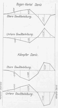
Abb. 7. Summen-Einflusslinien der Spannungen im Bogenviertel und im Kämpfer
