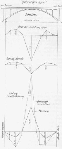
Abb. 6. Summen-Einflusslinien der Spannungen im Scheitel.
