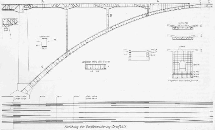
Abb. 3. Armierungsplan der Brücke, Masstab 1: 150.
