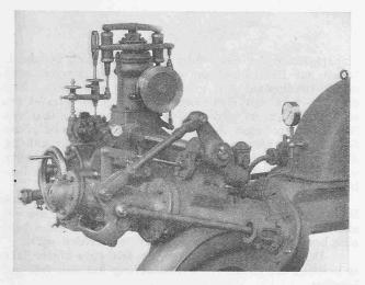
Abb. 23. Einlauf-Seite der 1500 PS-Freistrahlturbine
