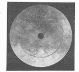
Abb. 13. Klangfigur 0/1 einer 2 mm starken Kupferscheibe mit freiem Rand. d/D = 30/300, f = 170,5 Hertz.
