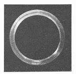
Abb. 22. Klangfigur 1/ einer 2 mm starken Kupferscheibe mit freiem Rand. d|D = 210/300, f = 333 Hertz.
