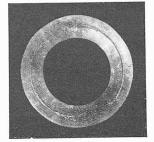
Abb. 21. Klangfigur 0/1 einer 2 mm starken Kupferplatte mit freiem Rand. d/D = 240/300, f = 298 Hertz.
