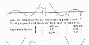
Abb. 20. Klangfigur 0/2 der Kupferscheibe gemäss Abb. 19. Schwingungszahl nach Rechnung 1423, nach Versuch 1478, 9,32 cm, 9,32 cm, Knotenkreis-Radien { 13,40 " 13.40 ...
