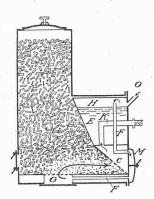
Abb. 1. Schematische Darstellung des Gas-Generators von Barbier.
