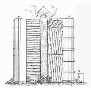
Abb. 3. Schematische Darstellung eines transportablen Verkohlungs-Ofens.
