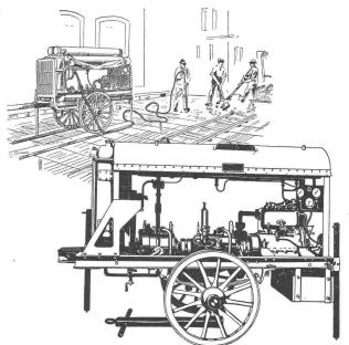
Fahrbare Kompressoranlage für Strassenbau.
