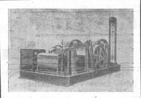
Schrägaufzugswinde von 16 Ts Zugkraft, zweimal geliefert an Kraf werk Wäggital.
