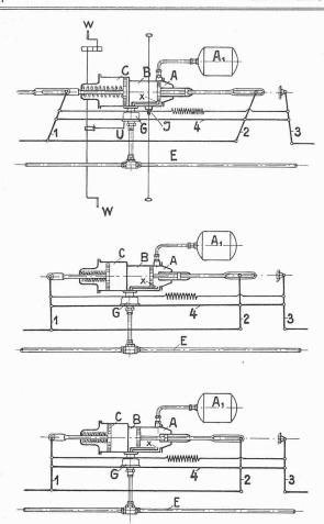
Abb. 1 bis 3. Schema der Kunze-Knorr-Güterzugbremse.
