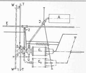
Abb. 4. Schema der Westinghouse-Güterzugbremse (Französischer Versuchszug 1926).
