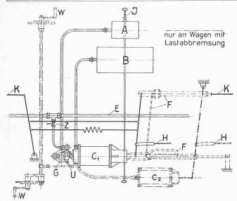
Abb. 5. Schema der Drolshammer-Güterzugbremse (Schweizerischer Versuchszug 1927).
