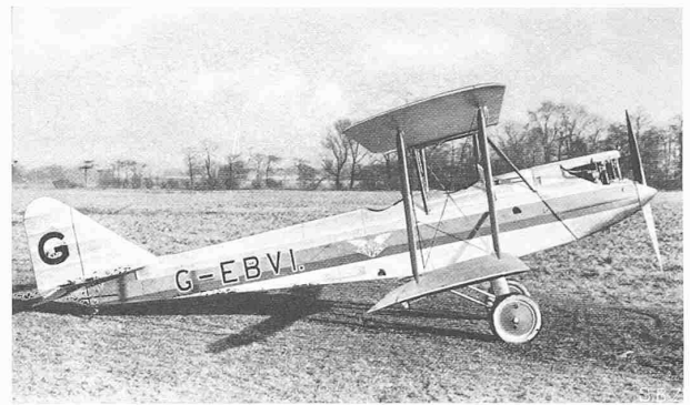
Abb. 33. Sportflugzeug Avro „Avian“ mit 60/80 PS Cirrus-Motor, wurde von Hinkler für seinen 15-tägigen Raid London-Australien benutzt.
