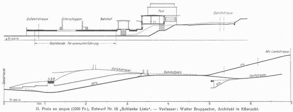
Längenprofil der beiden Strassenunterführungen 1:4000/1:800, und Querschnitt durch die Bahnhof-Anlage 1:800. — Darunter Uebersichtsplan 1:4000.
