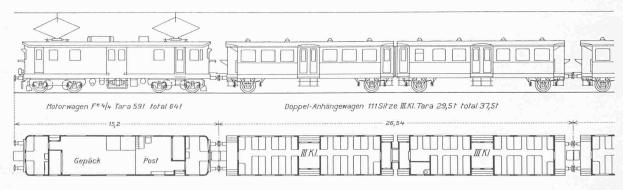
Abb. 1 und 2. Vorortzug der Schweizerischen Bundesbahnen für Pendelverkehr, geliefert von der Schweizer. Wagonsfabrik Schlieren,
