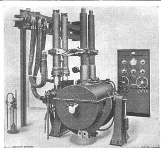
Elektrischer Metallschmelzofen für Dreiphasenstrom, mit hydraulischer Hand- und automatischer Elektrodenregulierung, gsvermögen 600 kg. Ansicht von der Ausgusseite.
