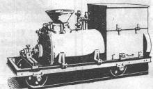
Mit dieser Cementinjectionsmaschine, Patent,
