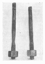
Abb. 23 und 29. Innere und äussere Defekte an Zugstangen-Enden.
