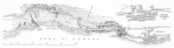
Abb. 20. Lageplan vom Sasso Pianca bis Gandria 1:6000. — Oben rechts Variante in Gandria 1:3000 (vergl. oben). Die gestrichelten Linien zwischen unterer Strasse und Fussweg bezeichnen das Projekt Cremonini, bezw. seine äussere Strassenkante.
