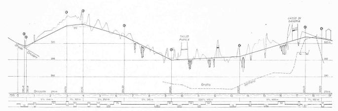
Abb. 22. Längenprofil des untern Tracé Antonietti. — Masstab für die Abb. 21 u. §22: Längen 1:10000, Höhen 1:1000.
