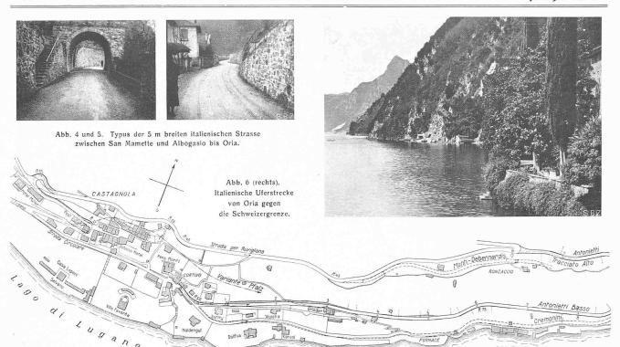
Abb. 7. Lageplan von Castagnola bis San Domenico. — Masstab 1:6000. — Gestrichelt die ältern Projekte (zum Vergleich).
