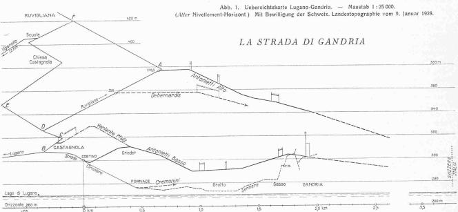
Abb. 2. Uebersichts-Längenprofil Castagnola-Gandria. — Reduziert auf den neuen Nivellement-Horizont. Längen 1:2000, Höhen 1:2000.
