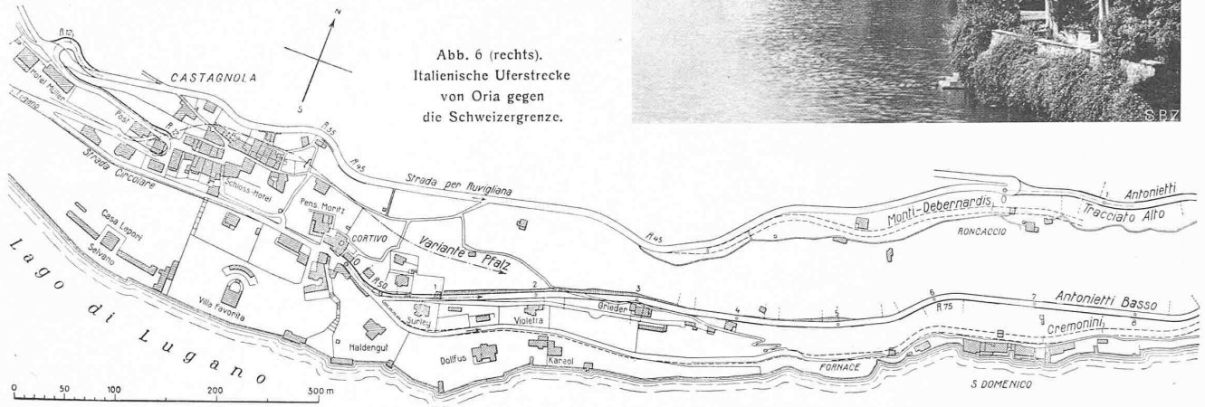
Abb. 7. Lageplan von Castagnola bis San Domenico. — Masstab 1 : 6000. — Gestrichelt die ältern Projekte (zum Vergleich).
