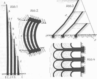
Abb. 1 bis 4. Gewölbe-Staumauern mit abgestuften Druckhöhen.
