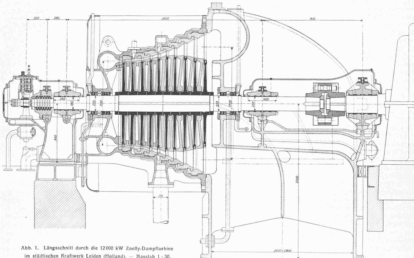
Abb. 1. Längsschnitt durch die 12000 kW Zoelly-Dampfturbine im städtischen Kraftwerk Leiden (Holland). — Maßstab 1 : 30.
