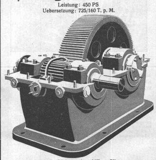
Ritzel mit gehärteten und geschliffenen Zähnen Rad mit gehobelten Zähnen
