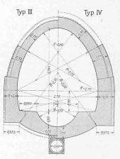
Abb. 3. Stärkste Druck-Typen des vorgeschenen Profils. - 1:80.
