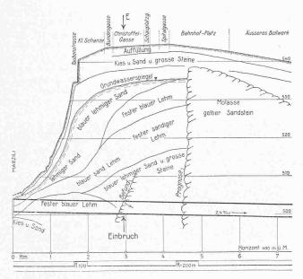
Abb. 4. Längenprofil mit geologischer Prognose. - Masstab 1:8000/800.
