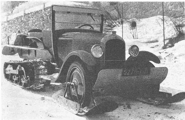
Abb. 1. Citroën-Automobil mit Raupenbandantrieb und Kufen.
