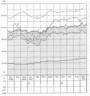
LEGENDE: OX-A aus Fluss-Kraftwerken gewonnene Leistung; A-B in Saison-Speicherwerken erzeugte Leistung; B-C kalorisch erzeugte Leistung und Einfuhr aus ausländischen Kraftwerken; OX-D auf Grund des Wasserzuflusses in den Flusskraftwerken verfügbar gewesene Leistung; OX-E durch den Export absorbierte Leistung; OX-F Höchstleistung an den der Monatsmitte zunächst gelegenen Mittwochen; abwärts gerichtete Ordinaten OX-G auf Monatsende in den Saison-Speicherwerken vorrättig gewesene Energie.
