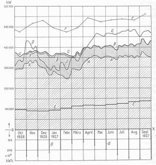
LEGENDE: OX-A aus Fluss-Kraftwerken gewonnene Leistung; A-B in Saison-Speicherwerken erzeugte Leistung; B-C kalorisch erzeugte Leistung und Einfuhr aus ausländischen Kraftwerken; OX-D auf Grund des Wasserzuffusses in den Flusskraftwerken verfügbar gewesene Leistung; OX-E durch den Export absorbierte Leistung; OX-F Höchstleistung an den der Monatsmitte zunächst gelegenen Mittwochen; abwärts gerichtete Ordinaten OX-G auf Monatsende in den Saison-Speicherwerken vorrätig gewesene Energie.
