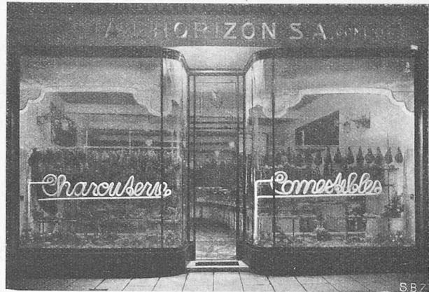
**Die Kältetechnik im Dienste der Reklame.** Eine originelle und wohlgelungene Verwendung von Kühlrohren zu Reklamezwecken zeigt das obenstehende Bild, das die Schaufenster eines Genfer Comestibles-Geschäfts wiedergibt, im übrigen keiner weiteren Erläuterung bedarf. Die stets von Reif bedeckten Röhren bilden zweifellos eine sehr wirkungsvolle Reklame. Näheres über die gesamte Kühl-anlage gibt die „Revue technique Sulzer“, Jahrgang 1926, Heft 3.
