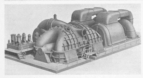
Abb. 1. Modell des 160 000 kW Dampfturbinen-Aggregats von BBC für die Zentrale Hell Gate in New York Im Vordergrund der Niederdruckzylinder, links die zwei Schnellschluss- und die vier Regelventile.
