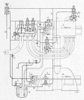
Abb. 4. Steuerungsschema der 160000 kW Dampsturbine für Hell Gate.
