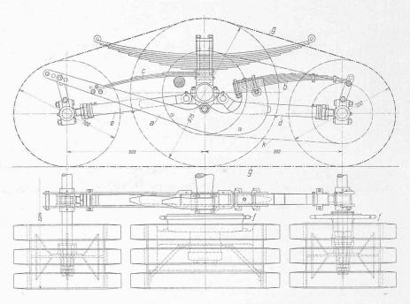
Abb. 2. Schema des Raupenband-Antriebes nach Nyberg. — Masstab 1:20.
