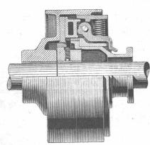
Benn-Kupplung, Typ NN, zur Verbindung zweier Wellen
