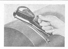
Pyrometer für Oberflächen-Temperaturen.
