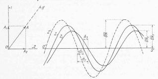
Fig. 4. Z': marche du rayon O'S' avant mise en charge. marches respectives des deux rayons O'S' après mise en charge.  $\overline{O'A}$ ,  $\overline{O'A_1}$ ,  $\overline{O'A_2}$ : amplitudes respectives de ces trois rayons.
