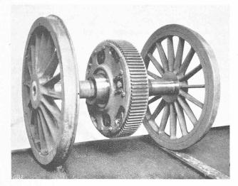
Abb. 4. Triebradsatz mit als Kupplungs-Gehäuse ausgestaltetem Zahnrad.
