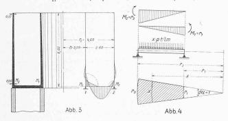
Zur Aufstellung der Elastizitäts-Gleichungen fehlen uns noch die Einflusszahlen und Belastungsglieder der an den Rändern in vertikaler Richtung unverschieblich gelagerten Kreisringplatte, d. h. die Randdrehungen  $a_{22}$ ,  $a_{12}$ ,  $a_{21}$ ,  $a_{11}$ ,  $a_{10}$ ,  $a_{20}$  infolge  $M_2 = 1$ ,  $M_1 = 1$ , und der gleichförmig verteilten Belastung p t/m² (Wasserhöhe).
