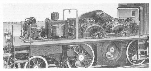
Abb. 3. Blick auf den vordern Teil eines Drehgestells bei abgehobener Schutzhaube.
