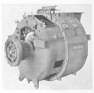
Abb. 4. Triebmotor von 460 kW (625 PS) Dauerleistung am Radumfang.
