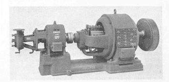
Abb. 7. Kühlgruppe für das Transformatoren-Oel.
