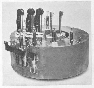
Abb. 2. Befestigung der Tensometer zur Messung der Ringdehnungen.
