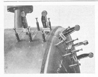
Abb. 4. Befestigung der Huggenberger-Tensometer an einem Dampfkessel.
