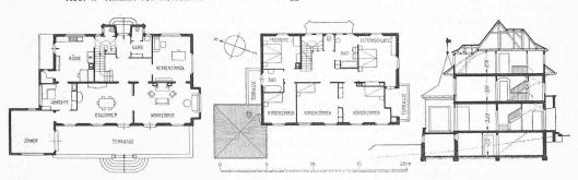
Abb. 5 bis 7. Landhaus R. Naef in Erlenbach bei Zürich. - Grundrisse und Schnitt 1:400.
