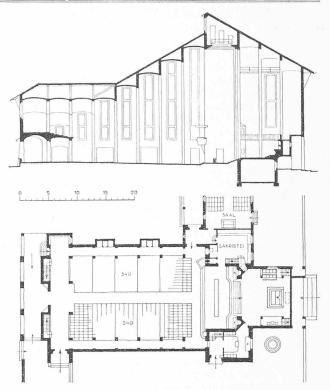
Abb. 5. Grundriss und Längsschnitt zu Abb. 4. — Masstab 1:600.
