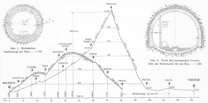
Abb. 2. Längenprofil des alten und des neuen Apennin-Uebergangs Bologna-Florenz. — Masstab für die Längen 1:75000, für die Höhen 1:7500.
