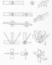
Abb. 7. Verbindungen der Beton-Bohlen. — 1:50.
