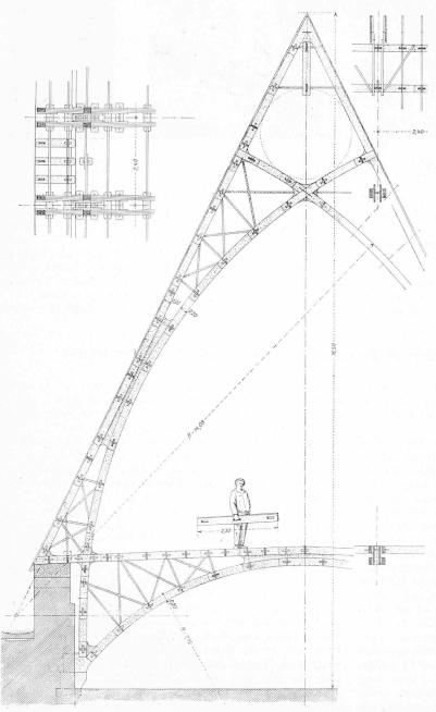
Abb. 6. Binder des Mittelschiff-Dachstuhls nach System Deneux. — Masstab 1:100.
