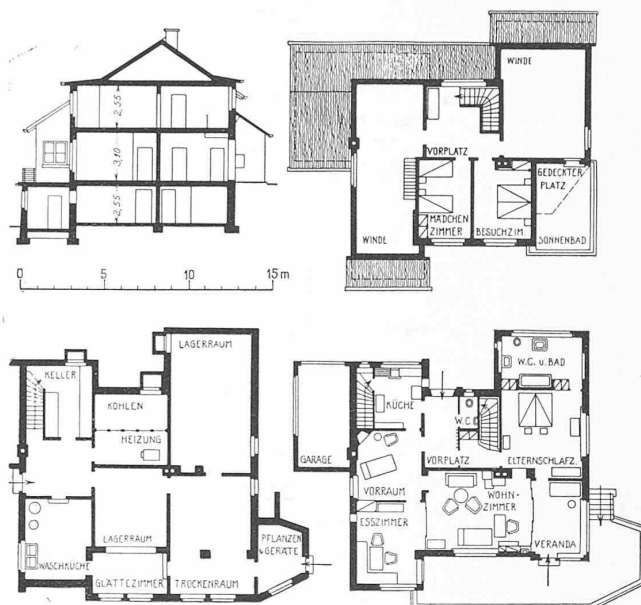
Abb. 4. Grundrisse und Schnitt. 1:400.
