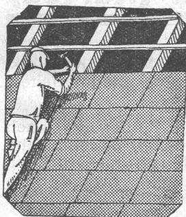
Diana-Unterdachplatten: Zweckmässigstes Dachunterkonstruktionsmaterial für Neu- und Umbauten. / Bei bestehenden Bauten können die Diana-Platten ohne Dachumdeckung leicht und rasch vom Dachinnern aus angebracht werden.
