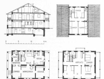
Abb. 1 bis 4. Haus Dr. Misslin in Flims. Grundrisse und Schnitt 1:400.
