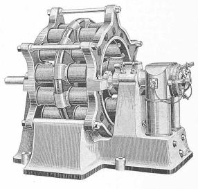
Abb. 4. Kapp'scher Wechselstrom-Generator der M. F. O. 1891.
