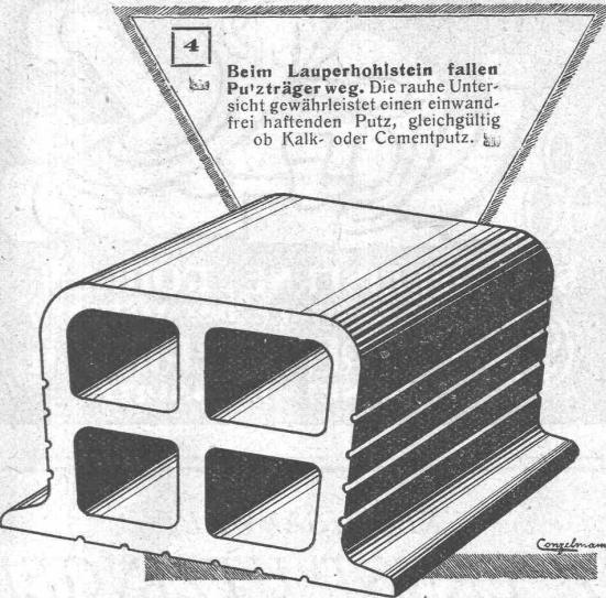
Beim Lauperhohlstein fallen Putzträger weg. Die rauhe Unterseite gewährleistet einen einwandfrei haftenden Putz, gleichgültig ob Kalk- oder Cementputz.
