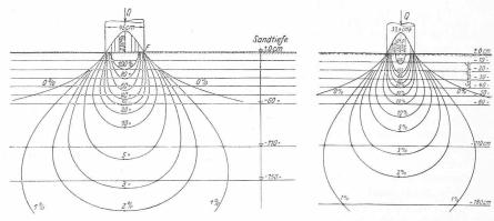
Abb. 3 und 4. Kurven gleichen lotrechten Druckes (Isobaren) zu den Abb. 1 und 2.
