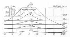
Abb. 1 und 2. Prozentkurven der Druckverteilung in trockenem Sande für verschiedene Tiefen.
